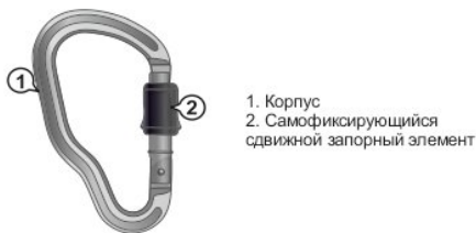
Рис. 1. Общий вид и составные детали соединительных элементов
