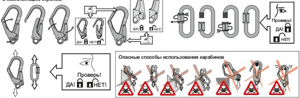
Рис. 7. Способы крепления стропов к анкерным устройствам
