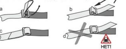
Рис. 4. Использование пряжек DUPLEX
