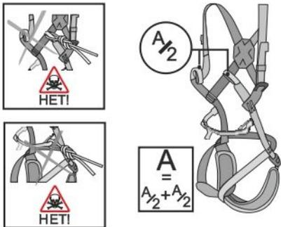
Рис. 3. Использование двухщелевых пряжек
