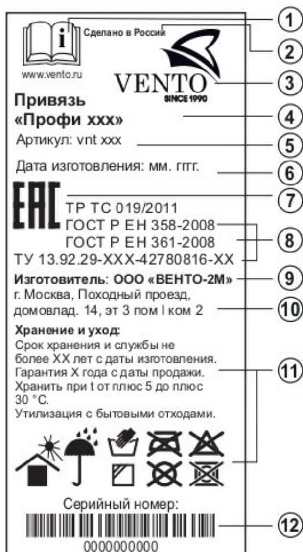
Рис. 2. Индивидуальная маркировка изделия
