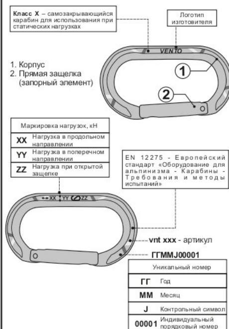
Рис. 1. Внешний вид, составные части, маркировка и характеристики карабина
