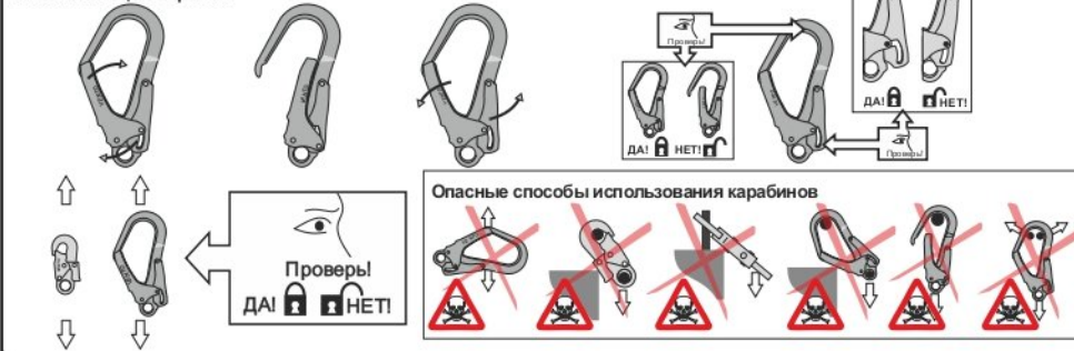
Рис. 6. Способы крепления стропов к анкерным устройствам
