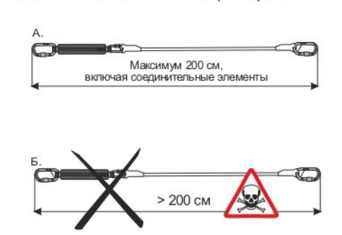
Рис. 9. Использование совместно с амортизаторами
