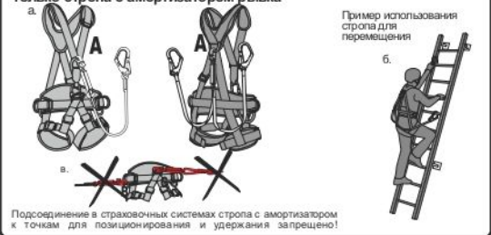
Рис. 6. Использование карабинов, входящих в состав стропов
