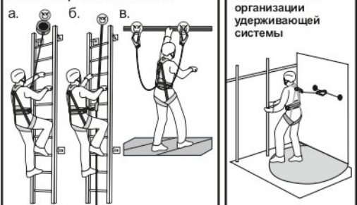
Рис. 13. Пример организации системы канатного доступа
