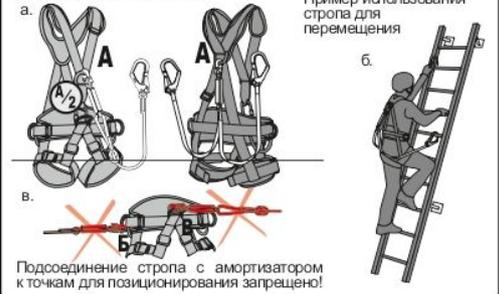
**Рис. 6. Краткая пиктографическая информация по использованию карабинов, входящих в комплектацию стропов.**
