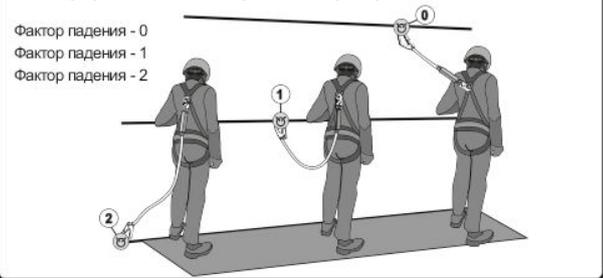
**Рис. 4. Расположение и назначение крепежных точек на привязях**
