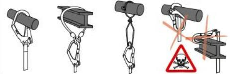
**Рис. 9. Ограничения по использованию стропов с амортизатором**
