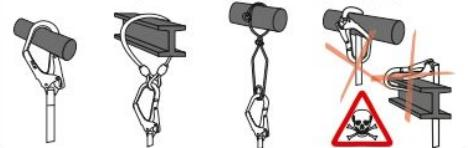
Рис. 9. Использование стропов без амортизатора.
