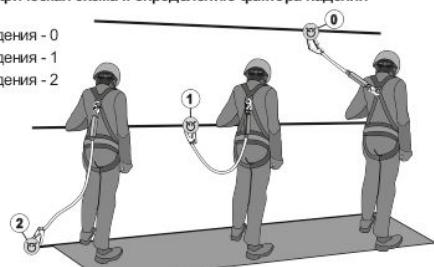
Рис. 4. Расположение и назначение крепежных точек на привязях
