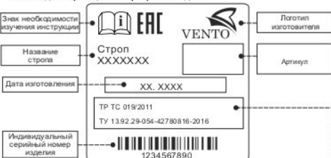
Рис. 2. Идентификация и маркировка изделия
