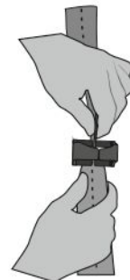
Рис. 4. Проведение ленты привязи
