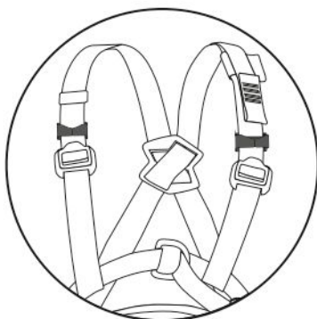
Рис. 5. Правильная установка скобы на ленте
