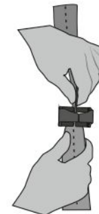
Рис. 4. Проведение ленты привязи
