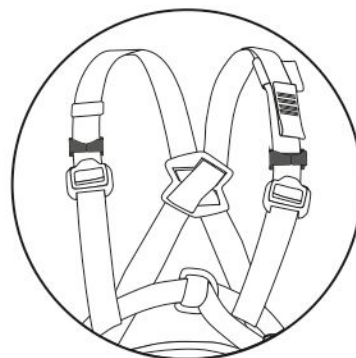
Рис. 5. Правильная установка скобы на ленте
