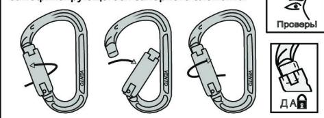
Рис. 4. Открытие / закрытие / фиксация самофиксирующегося запорного элемента.
