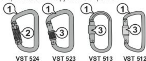
Рис. 4. Открытие / закрытие / фиксация запорного элемента с ручным запирающим
