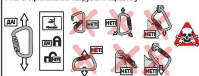
Рис. 3. Приложение нагрузки к карабину
