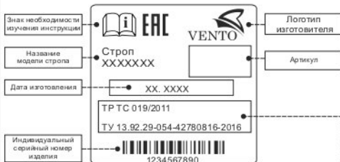
Рис. 2. Идентификация и маркировка изделия
