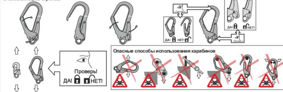
Рис. 6. Способы крепления стропов к анкерным устройствам
