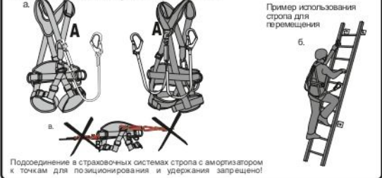
Рис. 6. Использование карабинов, входящих в состав стропов
