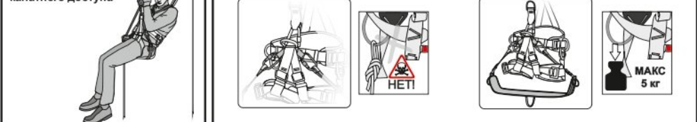
Рис. 18. Способ интеграции рабочего сиденья
