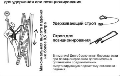
Рис. 12. Оборудование для удержания или позиционирования
