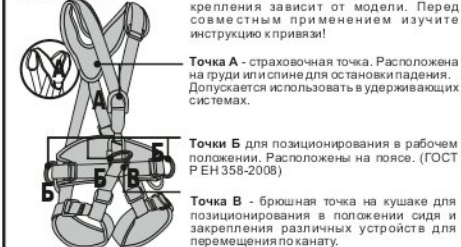
Рис. 5. Способы крепления к анкерным устройствам
