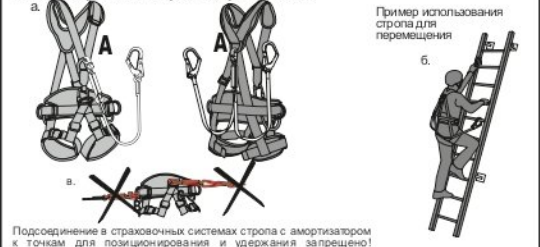
Рис. 6. Использование карабинов, входящих в состав стропов
