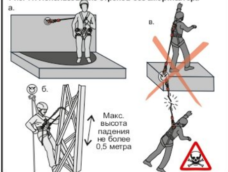
Рис. 11. Использование стропов без амортизатора
