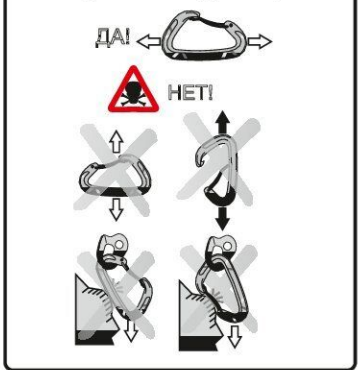
Рис. 6. Приложение нагрузки к карабинам
