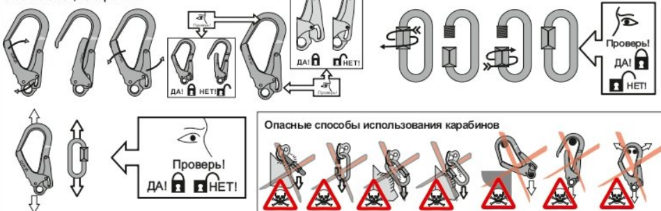
Рис. 7. Способы крепления стропов к анкерным устройствам
