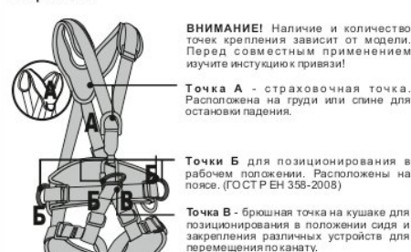
Рис. 4. Расположение и назначение крепежных точек на привязях
