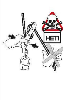
Рис. 13. Подъем с использованием зажима со стременом
