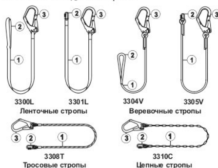
Рис. 1. Внешний вид, состав стропов
