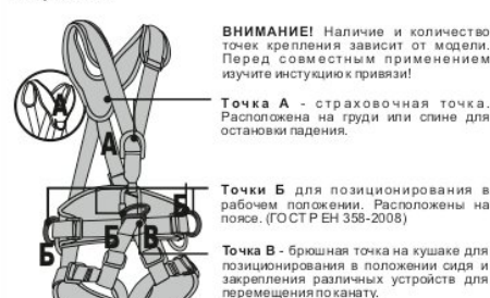
Рис. 4. Расположение и назначение крепежных точек на привязях
