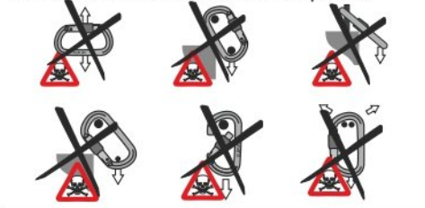
Рис. 4. Опасные способы использования карабинов
