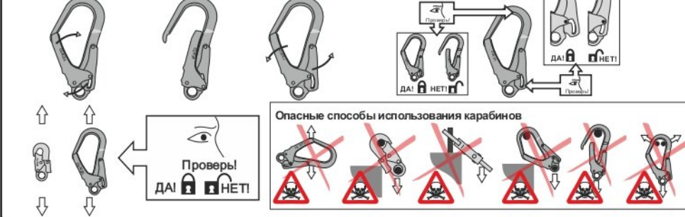
Рис. 6. Способы крепления стропов к анкерным устройствам
