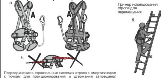
Рис. 6. Использование карабинов, входящих в состав стропов
