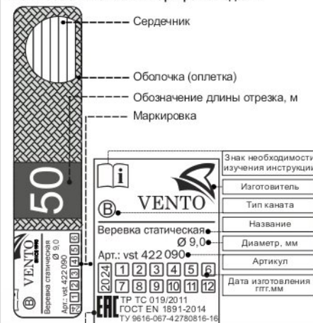
Рис. 1. Составные части и маркировка изделия
