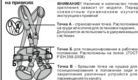
Рис. 5. Способы крепления к анкерным устройствам
