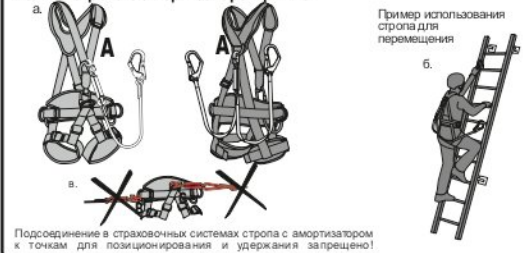
Рис. 6. Использование карабинов, входящих в состав стропов
