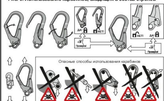
Рис. 6. Использование карабинов, входящих в состав стропов
