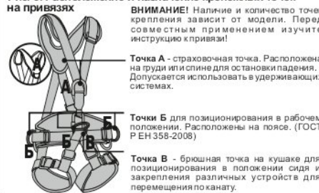
Рис. 5. Способы крепления к анкерным устройствам
