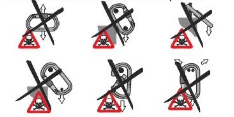
Рис. 4. Опасные способы использования карабинов
