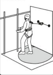
Рис. 12. Способ организации удерживающей системы
