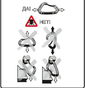
Рис. 6. Приложение нагрузки к карабинам
