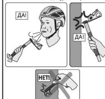
Рис. 10. Очистка ледобура от керна
