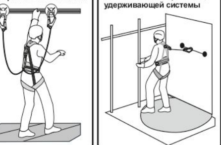
Рис. 11. Способ организации удерживающей системы
