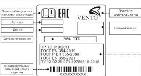
Рис. 2. Идентификация и маркировка изделия
