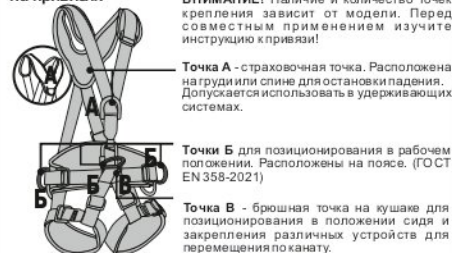
Рис. 5. Способы крепления к анкерным устройствам
