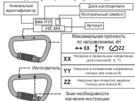
Рис. 1. Идентификация и маркировка изделия
