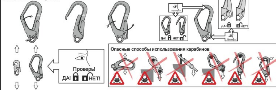
Рис. 6. Способы крепления стропов к анкерным устройствам
