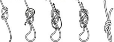
Рис. 3. Завязывание узла «восьмерка»
