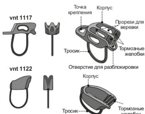
Рис. 1. Общий вид и составные части изделий
