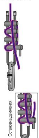
Рис. 5. Заправка веревки для медленного спуска
