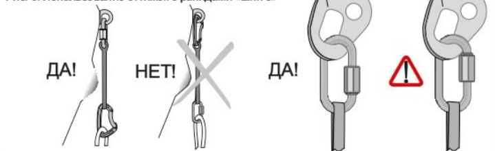
Рис. 6. Использование оттяжек с рапидами «Link 8»
