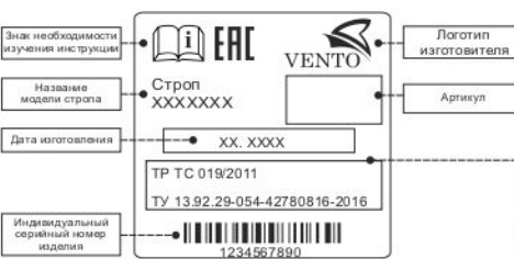
Рис. 2. Идентификация и маркировка изделия
