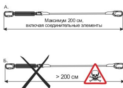
Рис. 9. Использование совместно с амортизаторами
