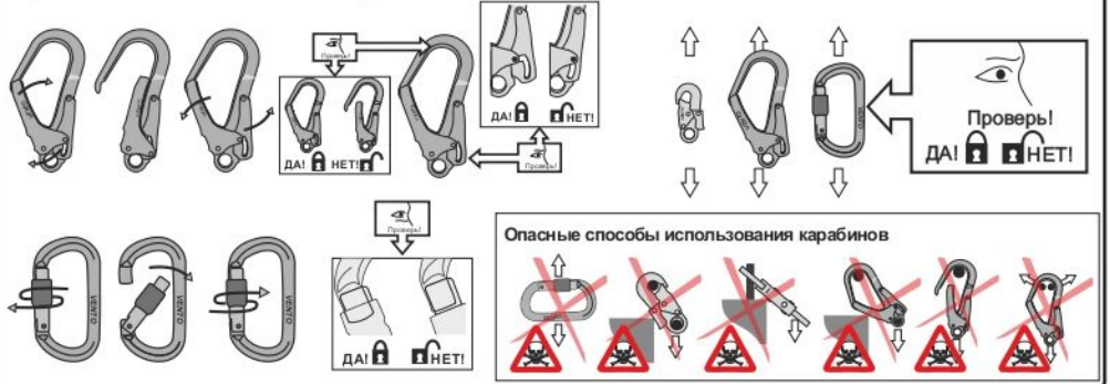
Рис. 6. Способы крепления стропов к анкерным устройствам
