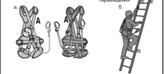
Рис. 4. В страховочных системах допускается использование только стропы с амортизатором рывка
