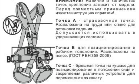
Рис. 3. Расположение и назначение крепежных точек на привязях
