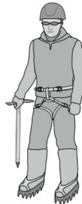
Рис. 5. Ледоруб в положении «трость»
