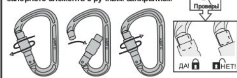
Рис. 5. Открытие / закрытие / фиксация запорного элемента с ручным запирающим
