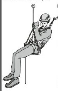
Рис. 13. Пример организации системы канатного доступа
