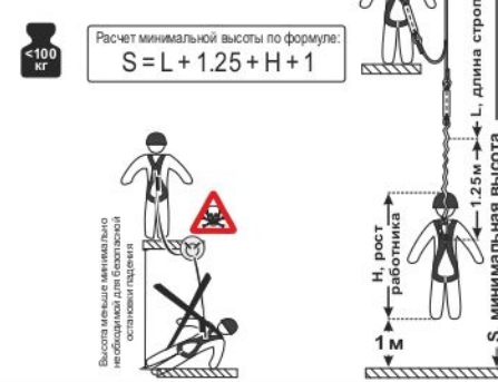
Рис. 9. Способы крепления к анкерным устройствам
