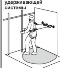
Рис. 19. Пример организации системы канатного доступа
